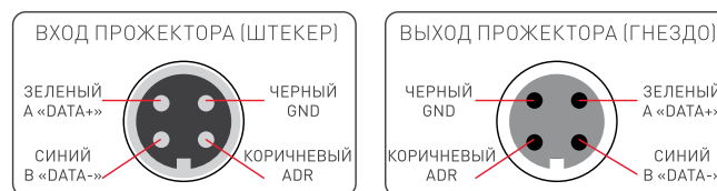
Цоколевка коннекторов на сигнальных кабелях
