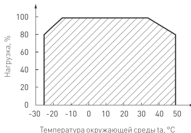
Рис. 2. Максимальная допустимая нагрузка, % от мощности источника
