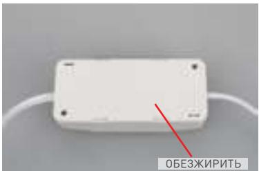
6. Обезжирьте поверхность на корпусе светильника.
