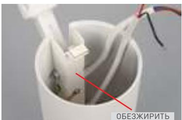
7. Прикрепите на обезжиренную поверхность драйвера и поверхность на корпусе светильника двусторонний скотч, например, DUAL LOCK 3M.
