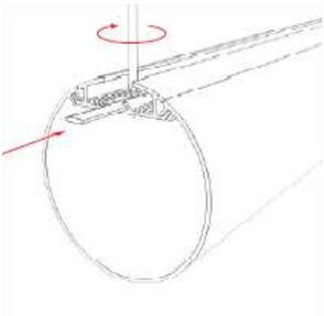
1. Просверлите отверстие и зафиксируйте соединитель на профиле.
