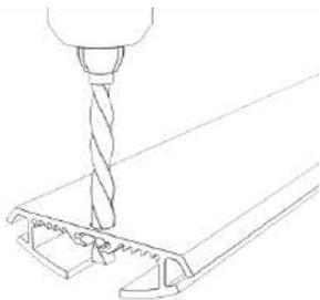
1. Просверлите отверстия для ввода кабеля питания.
