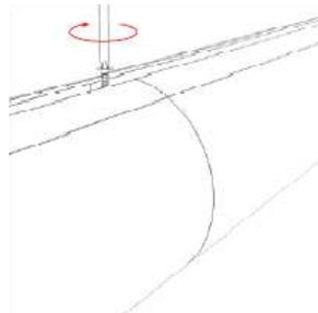
2. Соедините профили, просверлите отверстие и зафиксируйте их.
