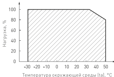
Рис. 2. Максимальная допустимая нагрузка, % от мощности источника
