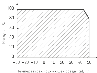
Рис. 2. Максимальная допустимая нагрузка, % от мощности источника
