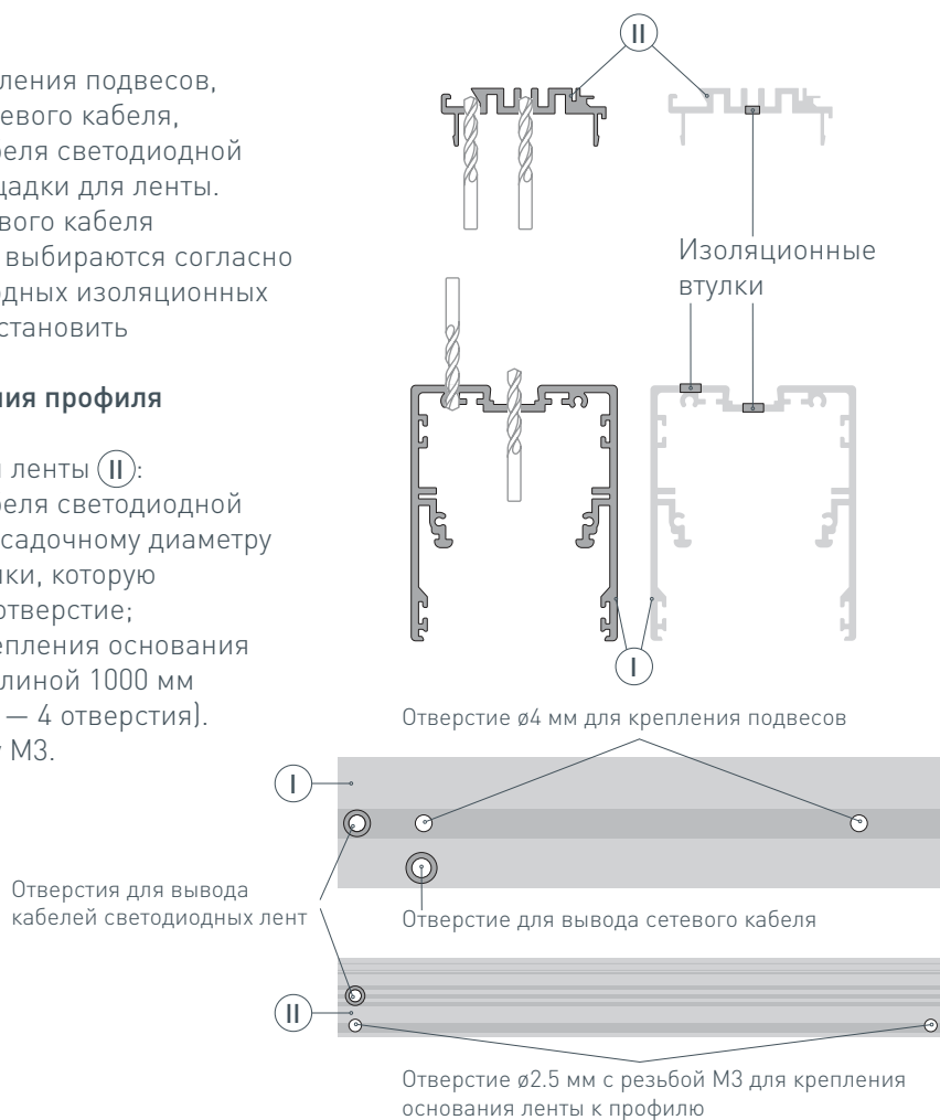
Рисунок 1. Профиль Ⓘ и основание для ленты Ⓜ , вид сверху
