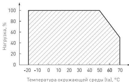
Рис. 2. Максимальная допустимая нагрузка, % от мощности источника
