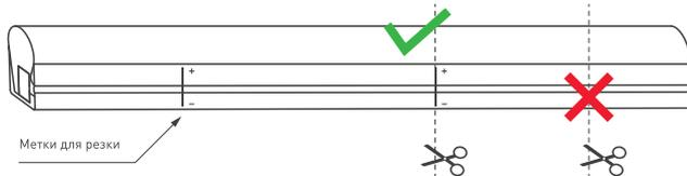
Найдите метки реза, обозначенные на корпусе ленты. Выполните разрез строго по нанесенной линии.
