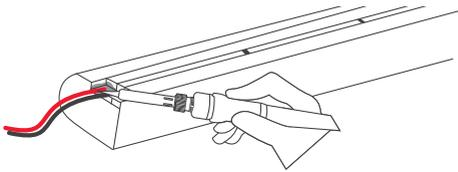
Распаяйте провод питания [арт. 026349] к контактным площадкам платы, соблюдая полярность подключения. Время пайки не должно превышать 5 секунд при температуре жала паяльника не выше 280 °С. Используйте только нейтральный флюс, после пайки удалите остатки флюса спиртовым растворителем.
