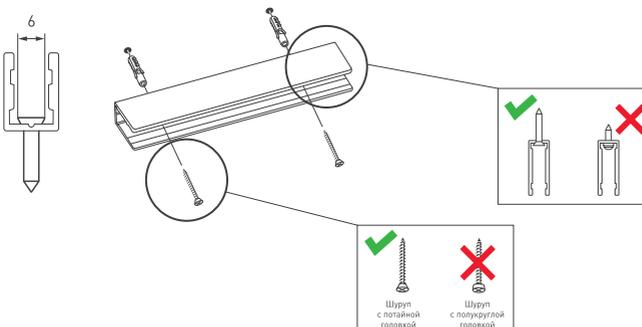
Выберите крепеж согласно рекомендациям. Диаметр крепежного отверстия — 3,5 мм. Максимальный диаметр головки шурупа — 6 мм. Используйте шурупы с потайной головкой.
