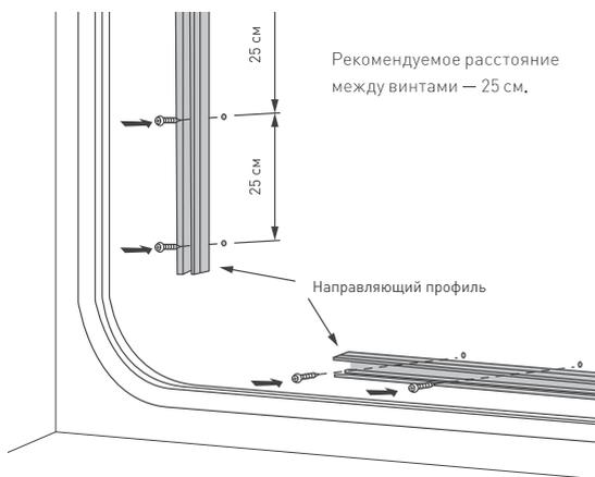
2.9.1. Рекомендуется оставлять технологические зазоры между отрезками профилей при монтаже, чтобы учесть изменения длины профиля при изменении температуры.
