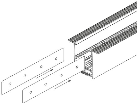
Рисунок 3. Установка соединителей в пазы шинопровода.
